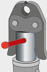
Seleccione la mordaza de prensado de acuerdo con las dimensiones de montaje y asegúrese de que las superficies del contorno estén limpias y lisas. A continuación, inserte la mordaza de prensado en la máquina de prensado adecuada abriendo y cerrando completamente el perno de retención.
