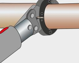
Mantenga pulsada la tecla de inicio durante aprox. 3 segundos para iniciar el proceso de prensado. El proceso de prensado se ejecuta automáticamente.
