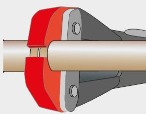
Abre la mordaza y coloca el accesorio con su tubo que se va a prensar en ángulo recto, de modo que el reborde del accesorio encaje en la ranura de la mordaza. ¿Coincide el borde exterior del accesorio con la marca de profundidad de inserción? Mantenga pulsada la tecla de inicio durante aprox. 3 segundos para iniciar el proceso de prensado. El proceso de prensado se ejecuta automáticamente.
