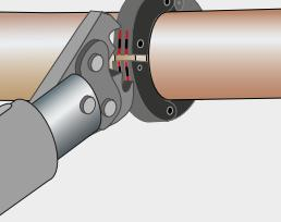
Gire el aro hasta la posición adecuada para acoplar la máquina de prensado. Abra la mordaza intermedia presionando hacia abajo la palanca y colóquela en el aro de forma que las garras de la mordaza intermedia se garren el aro. A continuación, compruebe que el borde exterior del accesorio y las marcas de profundidad de inserción coinciden.
