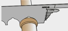
Compruebe la conexión mediante la plantilla de profundidad de inserción.
