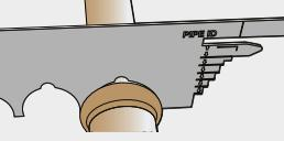
Compruebe la conexión mediante la plantilla de profundidad de inserción.
